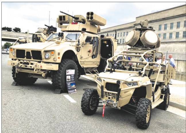
Комплекты средств ПВО ближнего действия Mk 1 (слева) и Mk 2 (справа) системы «Мадис»
