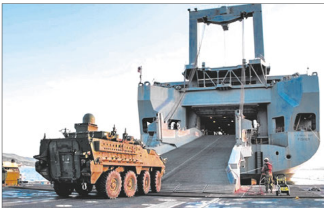
Погрузка боевой техники сухопутных войск США на крупнотоннажный среднескоростной роликер «Фишер» типа «Боб Хоуп»
